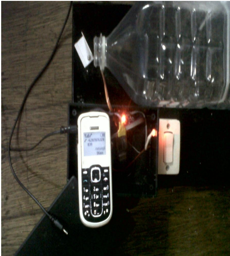
Gambar :Perangkat membuka pakan saat ditelpon pemelihara
