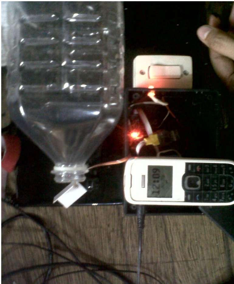
Gambar : Motor DC Membuka wadah pakan
